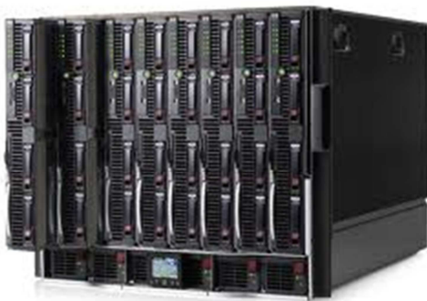
Figuur 9. Voorbeeld blade behuizing met blade servers
